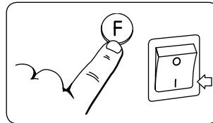
Podržte stlačené tlačidlo F a zapnite ho sietovým vypínačom.
