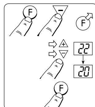
Podržte stlačené tlačidlo a jednou raz stlačte tlačidlo . Uvoľnite tlačidlo . 3-krát blikne indikátor a následne začne blikat aktuálne nastavená teplota. Stláčajte tlačidlá alebo dovtedy, pokiaľ sa na displeji nezobrazí rovnaká teplota ako je aktuálne nameraná teplota v miestnosti. Nastavanie uložte stlačením tlačidla na 5 sekúnd.
