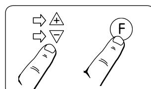
Ak ste najprv stlačili tlačidlo na zmenu nastavenia obmedzenia dennej teploty, 3-krát blikne indikátor a následne sa zobrazí náhodné číslo. Tlačidlami alebo zadajte správny deň v týždni (pondelok = 1, atď.). Potvrďte ho krátkym stlačením tlačidla .
