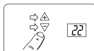
Začne blikáť 22 (°C). Vyberte požadovanú komfortnú teplotu. Stlačením tlačidla F na dlhšie ako 5 sekúnd voľbu potvrdíte.
