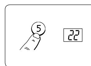
Na 5 sekúnd stlačte tlačidlo 5. Na displeji sa zobrazí nastavená komfortná teplota. LED indikátor nad tlačidlom 5 zostane súvislo svietiť a LED indikátor nad tlačidlom 7 začne blikať. Týmto ste na ďalších 5 hodín nastavili komfortnú teplotu.
