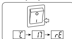
Po zapnutí ohrievača bude na displeji blikáť sekvencia °C – 17 – rE.
