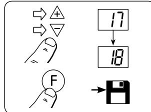
V režime obmedzenej teploty vyberte stláčaním tlačidiel ▲ alebo ▽ novú obmedzenú teplotu. Nastavenie uložte stlačením tlačidla Ⓛ na dlhšie ako 5 sekúnd.
