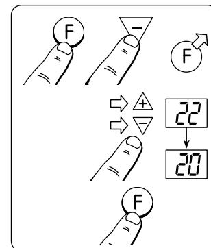
Podržte stlačené tlačidlo Ⓛ a jedn raz stlačte tlačidlo ▽. Uvoľnite tlačidlo Ⓛ. 3-krát blikne indikátor °C a následne začne blikat aktuálne nastavená teplota. Stláčajte tlačidlá ▲ alebo ▽ dovtedy, pokiaľ sa na displeji nezobrazí rovnaká teplota ako je aktuálne nameraná teplota v miestnosti. Nastavenie uložte stlačením tlačidla Ⓛ na 5 sekúnd.
