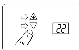
Začne blikáť 22 (°C). Vyberte požadovanú komfortnú teplotu. Stlačením tlačidla F na dlhšie ako 5 sekúnd volbu potvrdíte. Ak neurobíte nič, po 7 sekundach sa automaticky uloží nastavenie 22 (°C).
