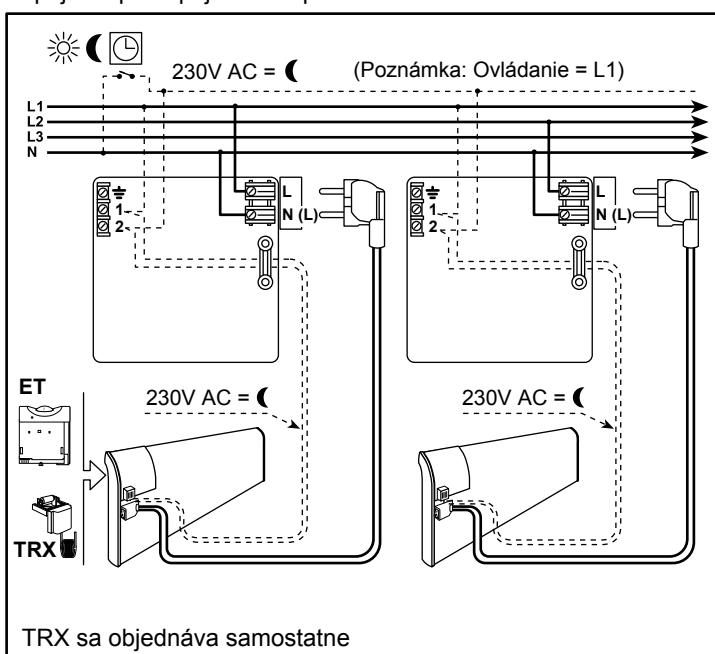
Zapojenie pri napájacom napäti 230 V
