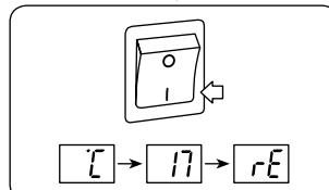
Po zapnutí ohrievača bude na displeji blikáť sekvencia °C – 17 – rE. Znamená to, že termostat bol dlhodobo odpojený a je ho treba reštartovať.
