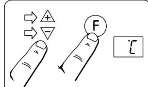
3-krát blikne indikátor a následne začne blikat aktuálne nastavená obmedzená teplota. Tlačidlami alebo nastavte požadovanú obmedzenú teplotu. Potvrďte ju krátkym stlačením tlačidla .
