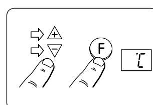
3-krát blikne indikátor °C a následne zostane súvislo blikáť indikátor 17 (°C). Tlačidlami ▲ alebo ▽ nastavte obmedzenú teplotu. Potvrďte ju krátkym stlačením tlačidla F.
