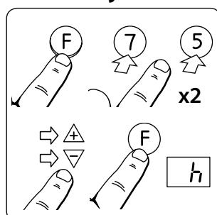
Podržte stlačené tlačidlo a dvakrát stlačte tlačidlo alebo . Uvoľnite tlačidlo . Indikátor (hodiny) 3-krát blikne.
