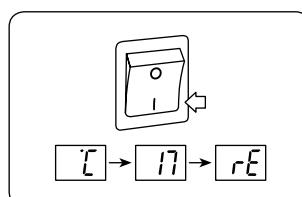
Po zapnutí ohrievača bude na displeji blikáť sekvencia °C – 17 – rE.
