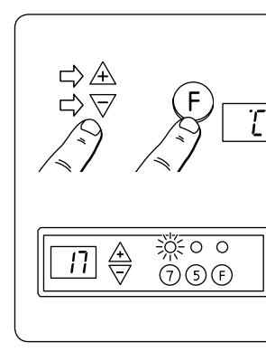
3-krát blikne indikátor °C a následne zostane súvislo blikáť indikátor 17 (°C). Tlačidlami ▲ alebo ▽ vyberte požadovanú obmedzenú teplotu. Potvrdte ju krátkym stlačením tlačidla F.
