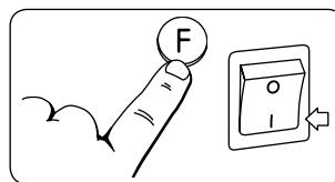
Podržte stlačené tlačidlo F a ohrievač zapnite sieťovým vypínačom.
