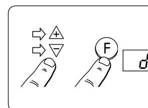
Na tri sekundy sa zobrazí indikátor d (deň). Následne začne blikať náhodné číslo (1 = pondelok, 2 = utorok, atď.). Tlačidlami ▲ alebo ▽ vyberte správny deň a potvrdte ho krátkym stlačením tlačidla F.
