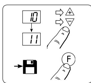
V režime obmedzenej teploty vyberte stláčaním tlačidiel ▲ alebo ▼ novú obmedzenú teplotu. Nastavenie uložte stlačením tlačidla F na dlhšie ako 5 sekúnd.
