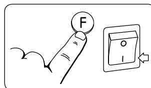
Podržte stlačené tlačidlo F a ohrievač zapnite sieťovým vypínačom.
