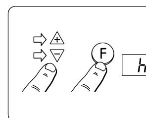
Tri sekundy bude blikať indikátor h (hodiny) a následne začne blikať indikátor 12 (hodín). Tlačidlami ▲ alebo ▽ nastavte dobu, počas ktorej má byť aktívne obmedzenie teploty (v hodinách). (Poznámka. K obmedzeniu teploty dôjde až po troch hodinách.) Potvrdte ju krátkym stlačením tlačidla F.
