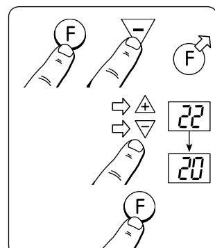
Podržte stlačené tlačidlo F a jeden raz stlačte tlačidlo ▽. Uvoľnite tlačidlo F. 3-krát blikne indikátor °C a následne začne blikať aktuálne nastavená teplota. Stláčajte tlačidlá ▲ alebo ▼ dovtedy, pokiaľ sa na displeji nezobrazí rovnaká teplota ako je aktuálne nameraná teplota v miestnosti. Nastavenie uložte stlačením tlačidla F na 5 sekúnd.
