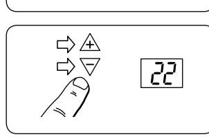
Začne blikáť 22 (°C). Vyberte požadovanú komfortnú teplotu. Stlačením tlačidla F na dlhšie ako 5 sekúnd volbu potvrdíte.
