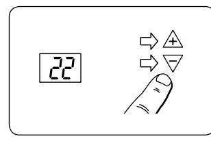
Začne blikat (). Vyberte požadovanú komfortnú teplotu. Slačením tlačidla na dlhšie ako 5 sekúnd voľbu potvrďte. Ak neurobíte nič, po 7 sekundách sa automaticky uloží nastavenie ().
